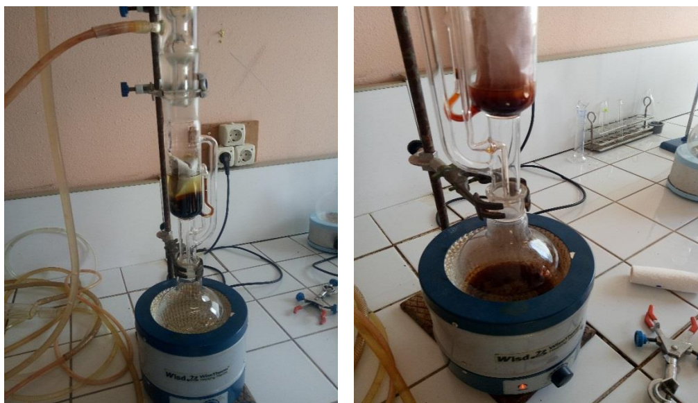
Figure 24 : Extraction par l'appareil soxhlet
