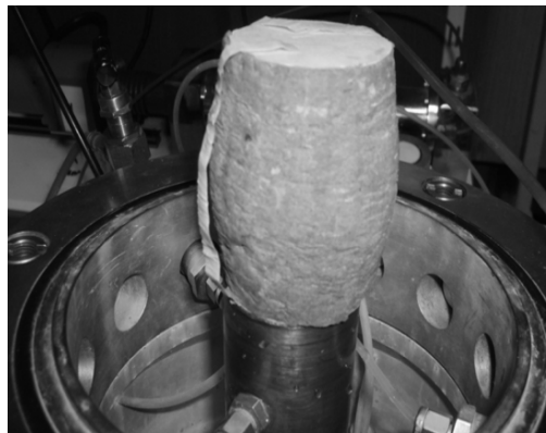
Figure II.41 – Forme de la rupture en tonneau des échantillons de limon d'Awans (Masekanya, 2008).
