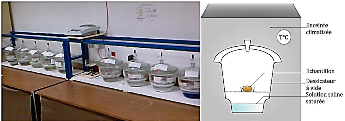
Figure IV.13 – Contrôle de la pression capillaire dans les dessiccateurs contenant des solutions salines saturées.
