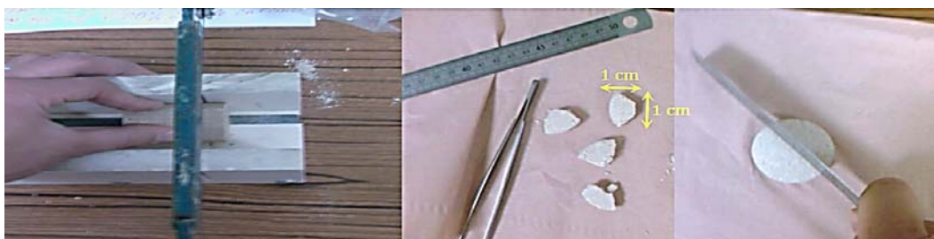
Découpage en galettes de la partie 80 mm et division en morceaux de la partie 10 mm
