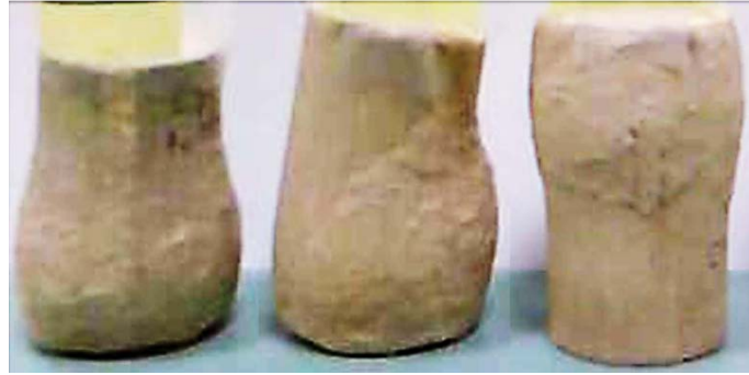
Figure V. 5 – Photos des échantillons du mélange TSCopt après cisaillement essais CD (échelle \frac{1}{2} ).
