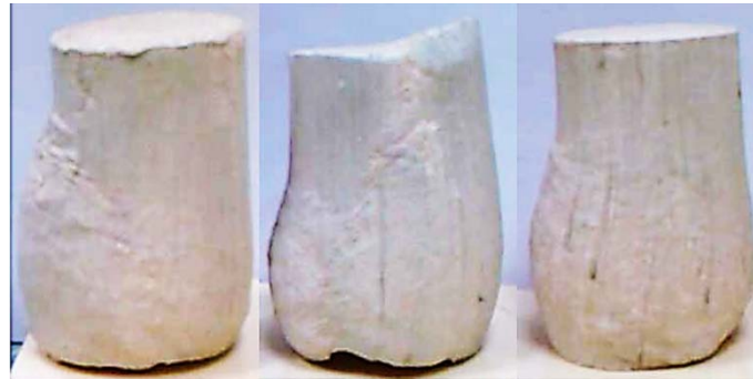
Figure V.7 – Photos des échantillons du mélange TSCopt après cisaillement essais CU (échelle \frac{1}{2} ).
