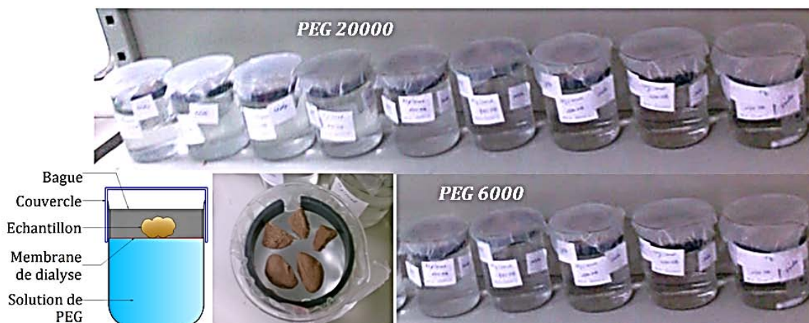
Figure IV.11 – Mise en place des échantillons dans les béchers à solutions osmotiques.
