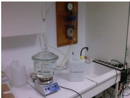
1. Préparation de l'eau désaérée
