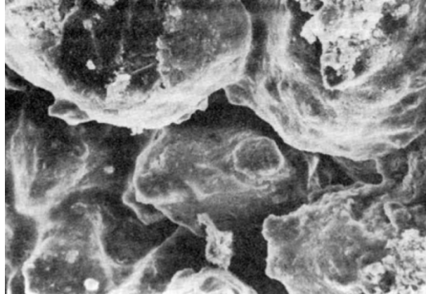
Figure I.23 – Microstructure d'un sable traité au ciment puis compacté (Vénuat, 1980).
