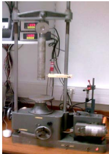
Figure III.8 – Presse WYKEHAM FARRANCE utilisée pour les essais de compression simple.
