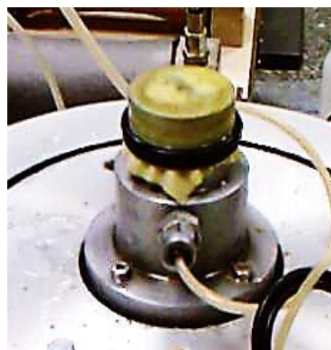
Figure V.13 – Photo de la base de la cellule Bishop-Wesley après modification.
