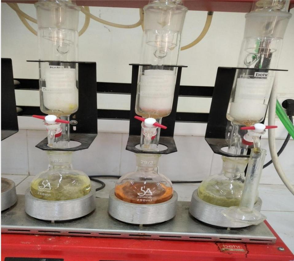
**Figure 07 : Appareil de soxhlet (Photo réalisée au laboratoire de biochimie)**
