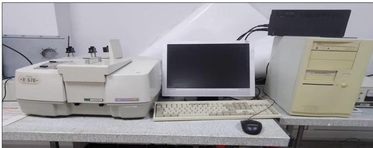
**Figure III-9 :** Photographie représente un spectrophotomètre.
