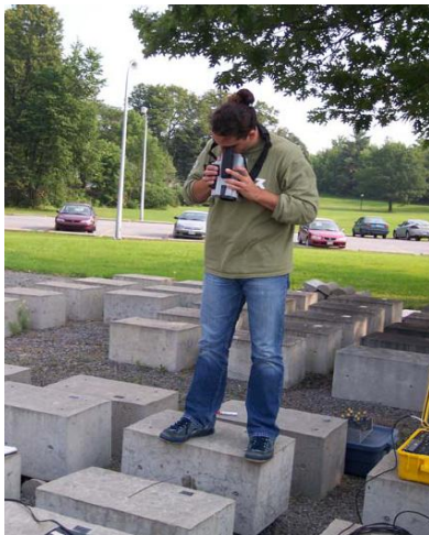
Figure 1.10 : mesures par thermographie infrarouge [Naar 06]
