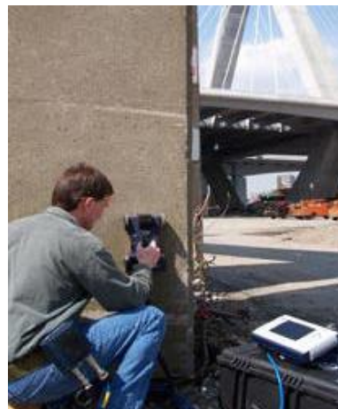
Figure 1.14 : Un système géoradar spécial pour les surfaces réduites.
