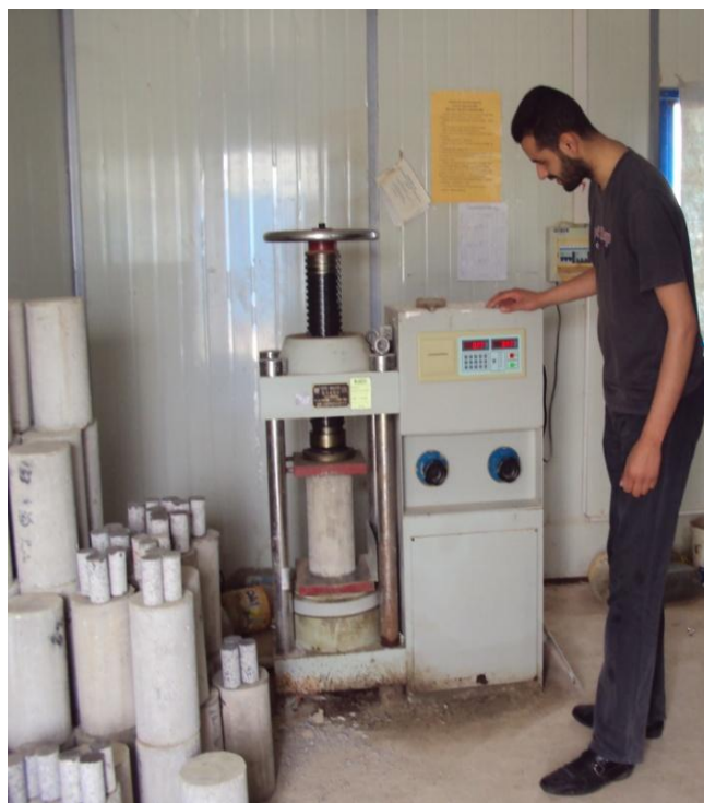
Figure 3.7 : Compression des éprouvettes en béton à la presse
