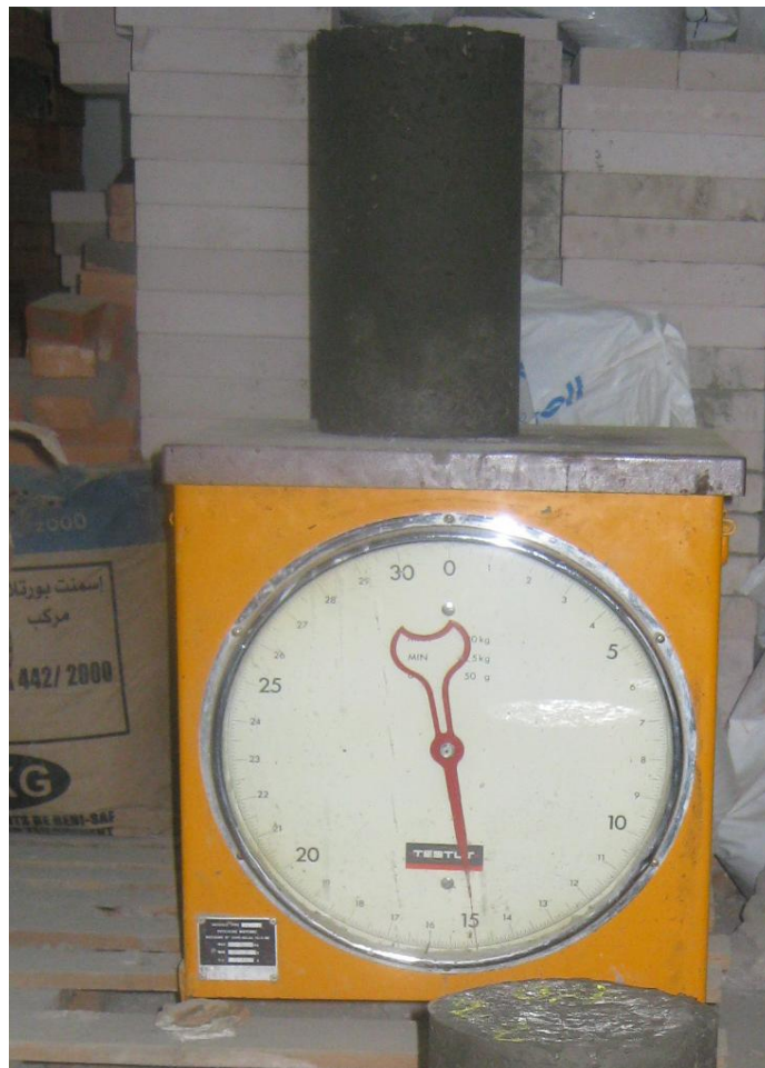
Figure 3.4 : Balance utilisée (Précision 0,1Kg)
