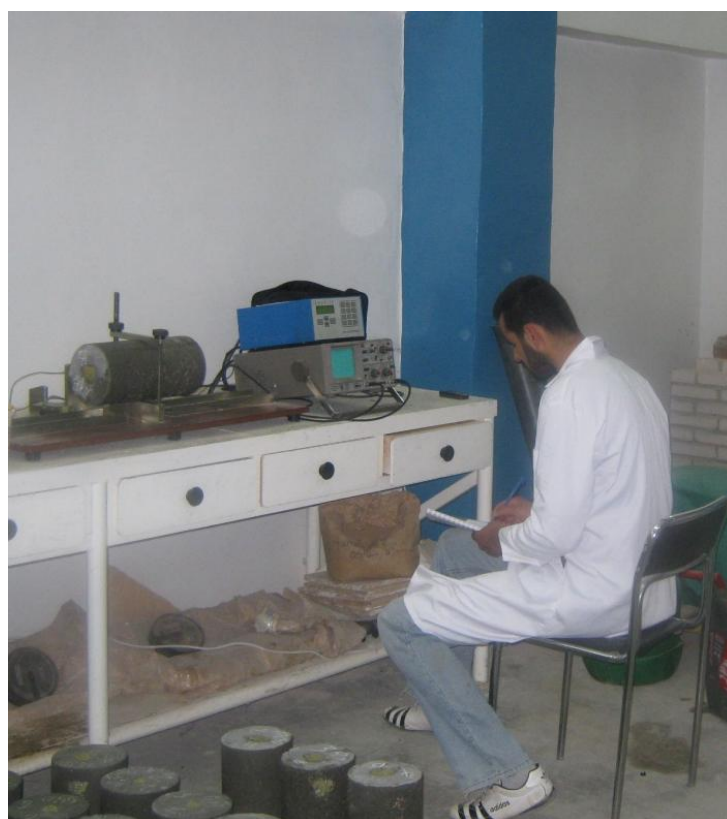
Figure 3.6 : Détermination des caractéristiques dynamiques (ERUDIT)
