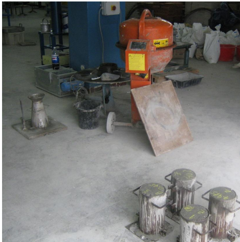
Figure 3.3 : Confection des éprouvettes cylindriques
