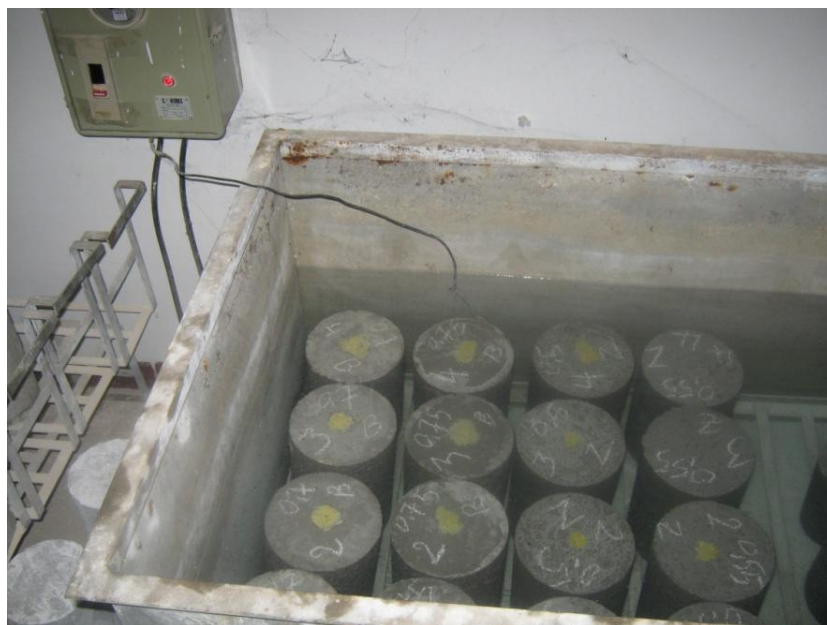
Figure 3.5 : Maturation des éprouvettes dans le bac thermostaté
