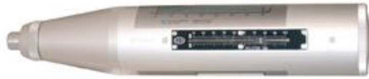
Figure 1.2 : scléromètre ou marteau de Schmidt
