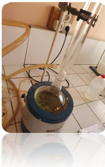
Figure 06 : Montage à reflux
