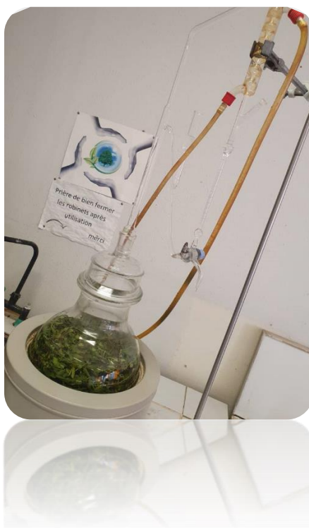
Figure 08 : Montage d'hydrodistillation (type Clevenger)
