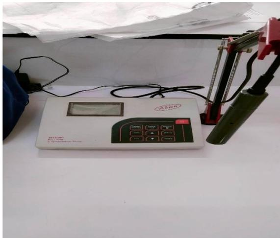
*Figure 19: Conductimètre de type Adwa AD3000.*
