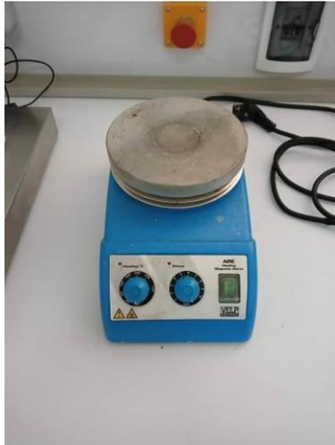
*Figure 25: Plaque chauffante avec agitateur.*
