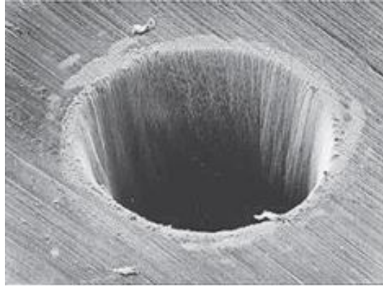
Figure 1.7 – Cratère formé par l'ablation laser d'une feuille épaisse d'acier en régime femtoseconde \lambda = 781nm . [25, 26]
