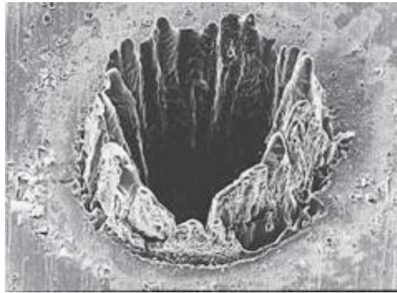
Figure 1.9 – Cratère formé par l'ablation laser d'une feuille épaisse d'acier en régime nanoseconde \lambda = 781nm . [25, 26]
