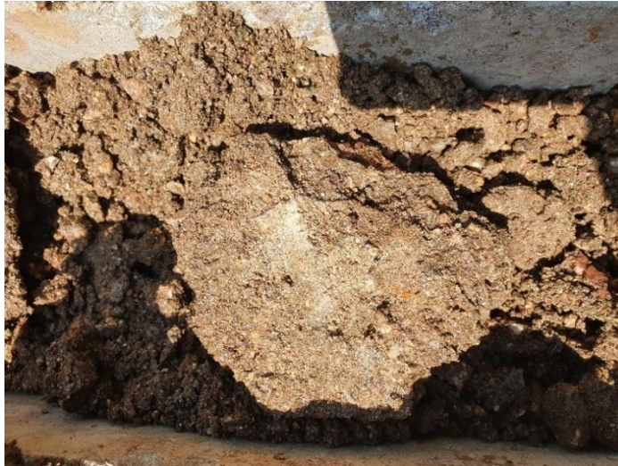
Figure II - 8 : Échantillon de CBR fragmenté montrant des plaques sèches dans la couche intermédiaire
