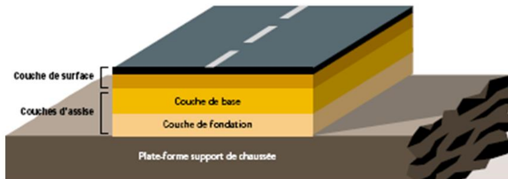
Figure I - 1 : Structure type d'une chaussée souple
