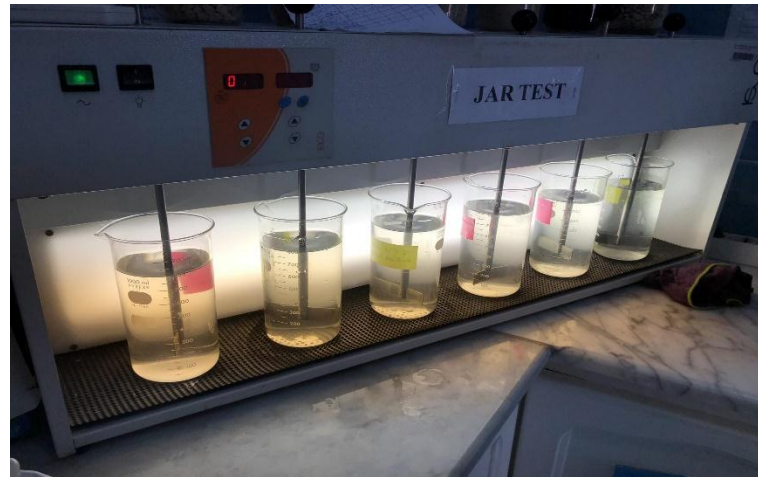
Figure 6: test du jar test effectué au niveau de la station de traitement de Sekkak.
