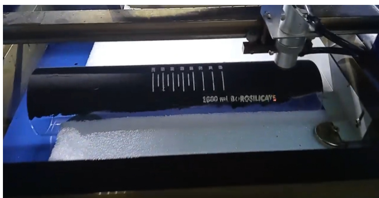
FIGURE 3.7 – Processus de gravure au laser CO 2 sur un tube en verre borosilicate.
