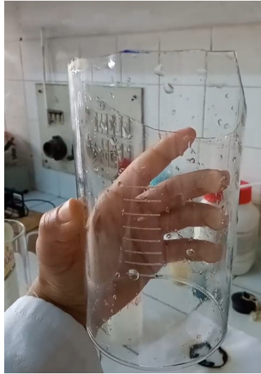
FIGURE 3.10 – Résultat de la découpe d'un bécher en borosilicate par jet d'eau.
