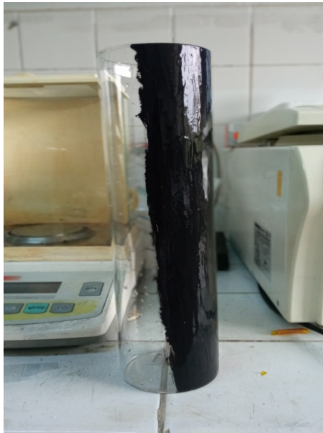
FIGURE 3.6 – Tube en borosilicate recouvert d'une couche de gouache.
