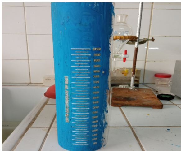
FIGURE 3.8 – Résultat final des graduations effectuées sur le bécher par laser.
