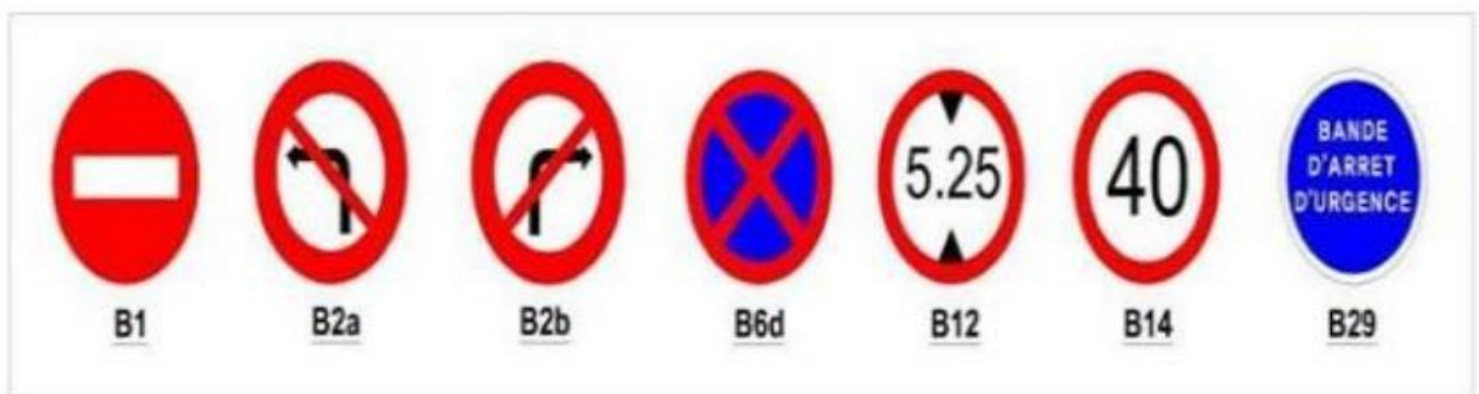
Figure4. 2 Les panneaux B
