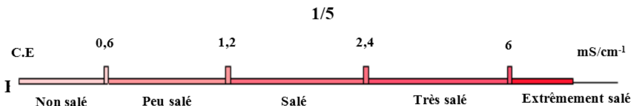
Fig. 71 : Échelle de salure en fonction de la conductivité de l'extrait aqueux au 1/5 (relation de RICHARDS IN AUBERT, 1978).
