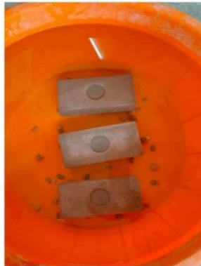
Figure 27 : immersion des échantillons dans l'eau
