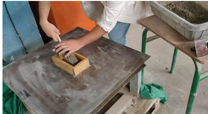
Figure 20 : serrage des pavés
