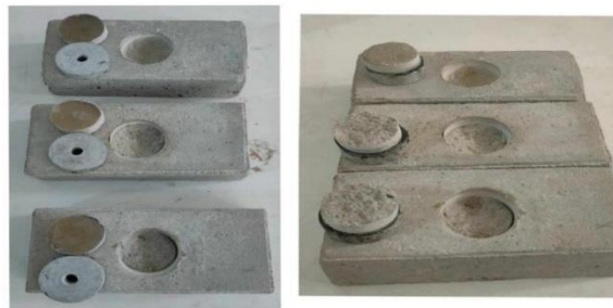
Figure 32 : les échantillons après l'essai d'adhérence :
