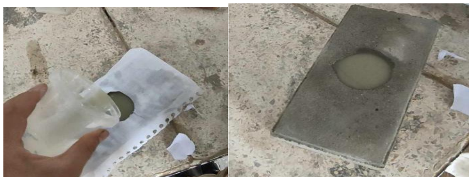
Figure 24 : Versement du mélange dans la partie supérieure de l'espace creux du pavé
