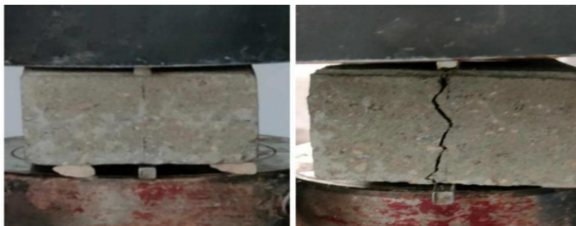
Figure 25 : essai traction par fendage
