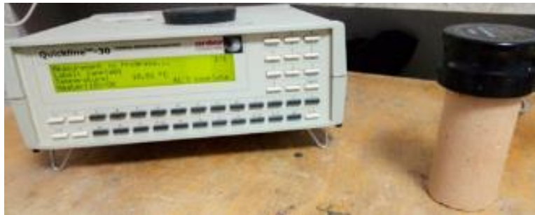
Figure II.17 : Dispositif de mesure de la conductivité thermique
