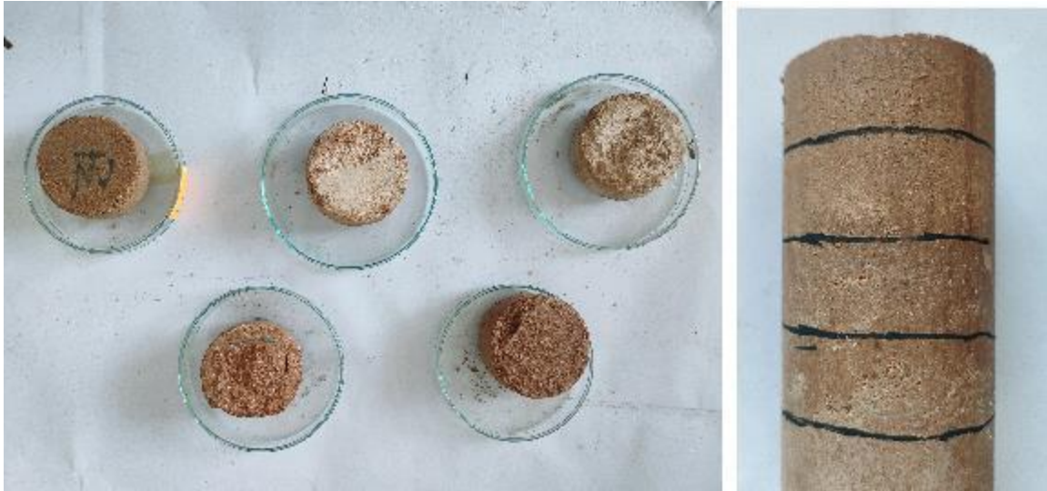
Figure II.19 : Détermination du front de remonté capillaire
