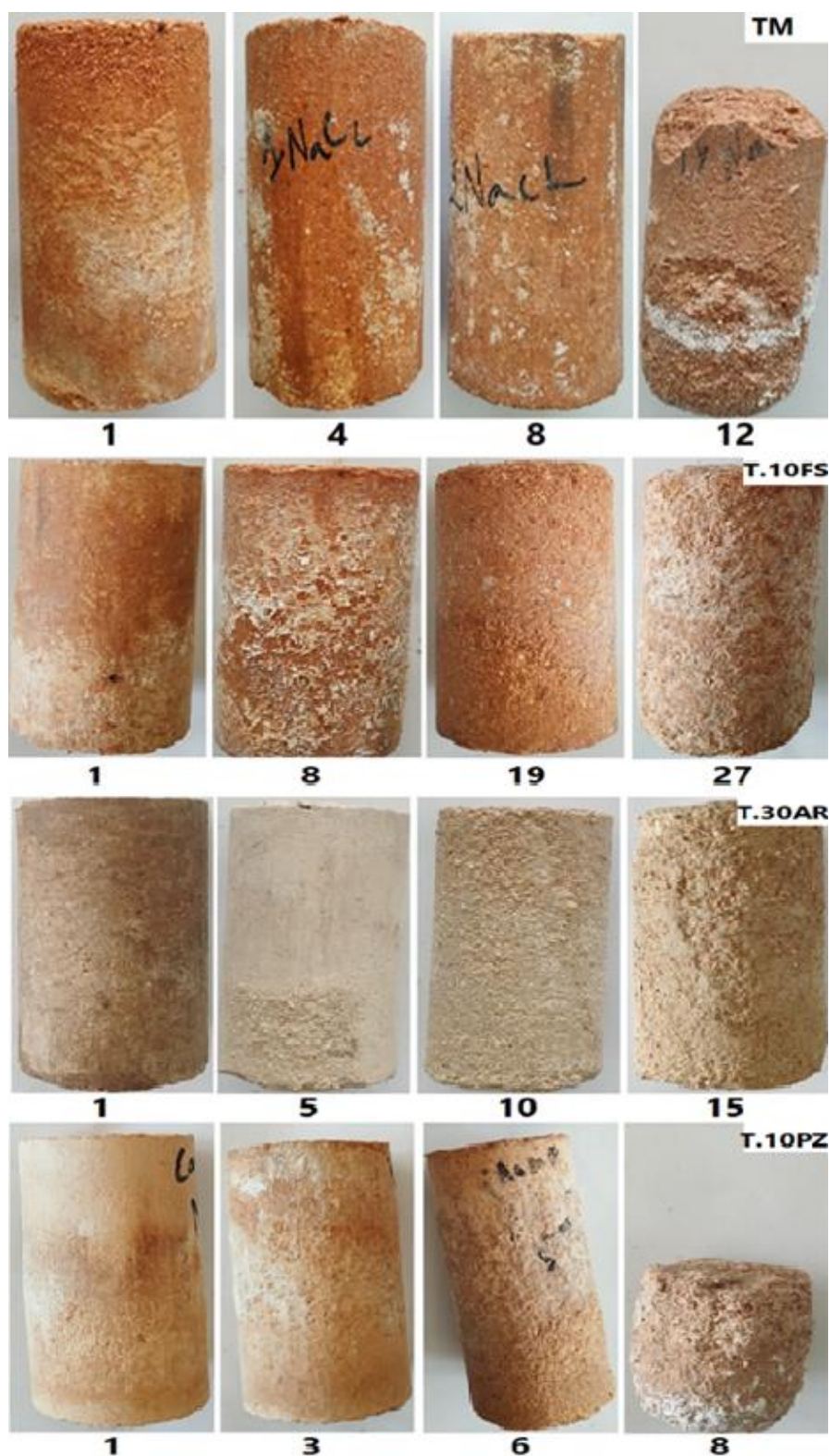
Figure IV.8 : Dégradation des échantillons suivant les cycles (immersion totale dans solution NaCl)
