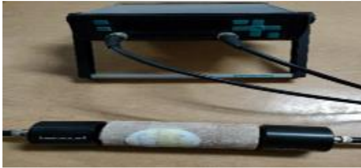
Figure II.16 : Dispositif de mesure de la vitesse d'impulsion ultrasonique
