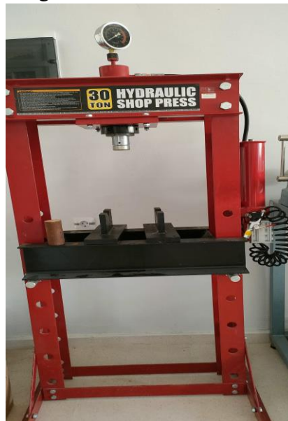
Figure II.21: Presse utilisé pour la confection des briques
