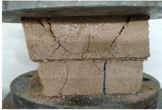
Figure II.22: Schéma de l'essai de compression
