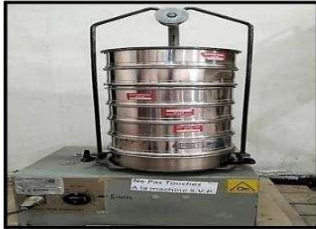
Figure 3.8 : Essai d'analyse granulométrique.
