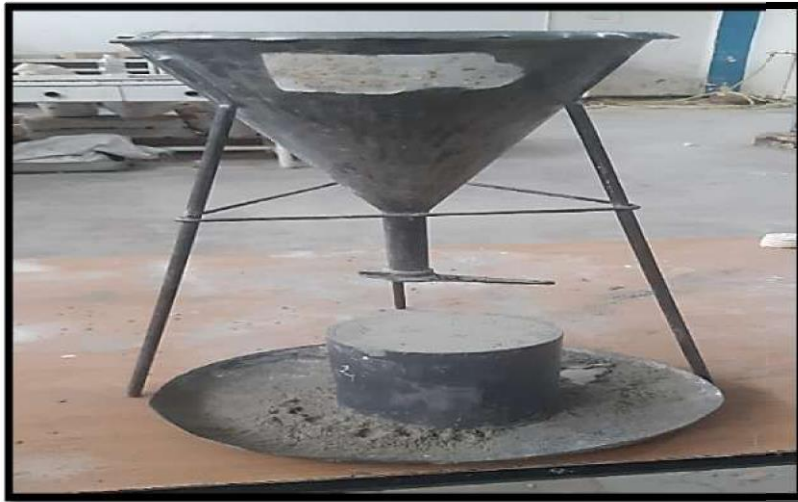
Figure 3.2 : Essais de mesure de la masse volumique apparente.
