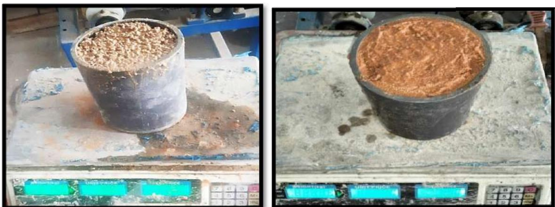
Figure 3.13 : Essai de foisonnement du sable et teneur en eau.
