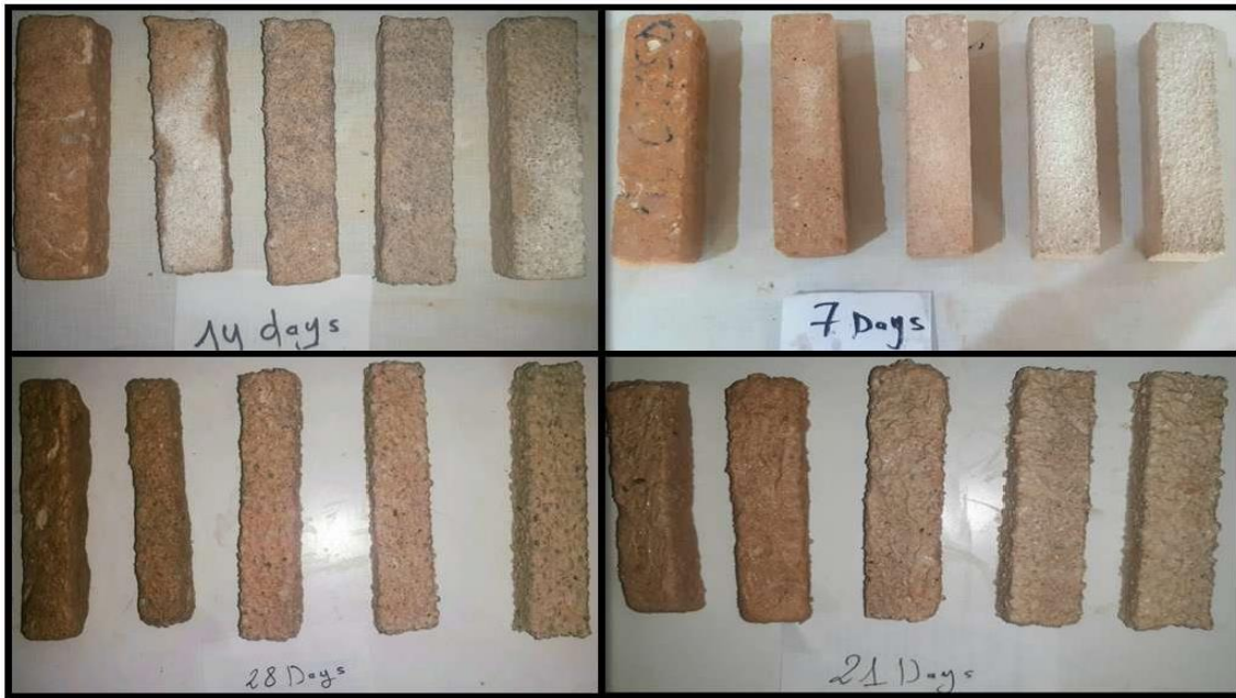
Figure 4.2 : Epreuve du mortier conservé en H_2SO_4
