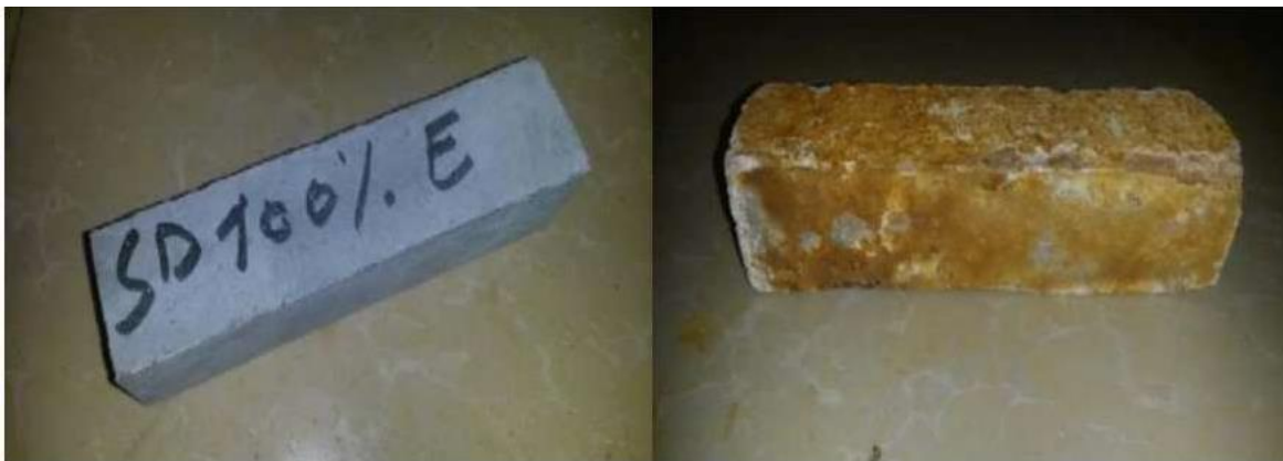
Figure 1.17 : (a) Échantillons conservés dans l'Eau (b) Échantillons conservés dans le milieu agressif. [34]
