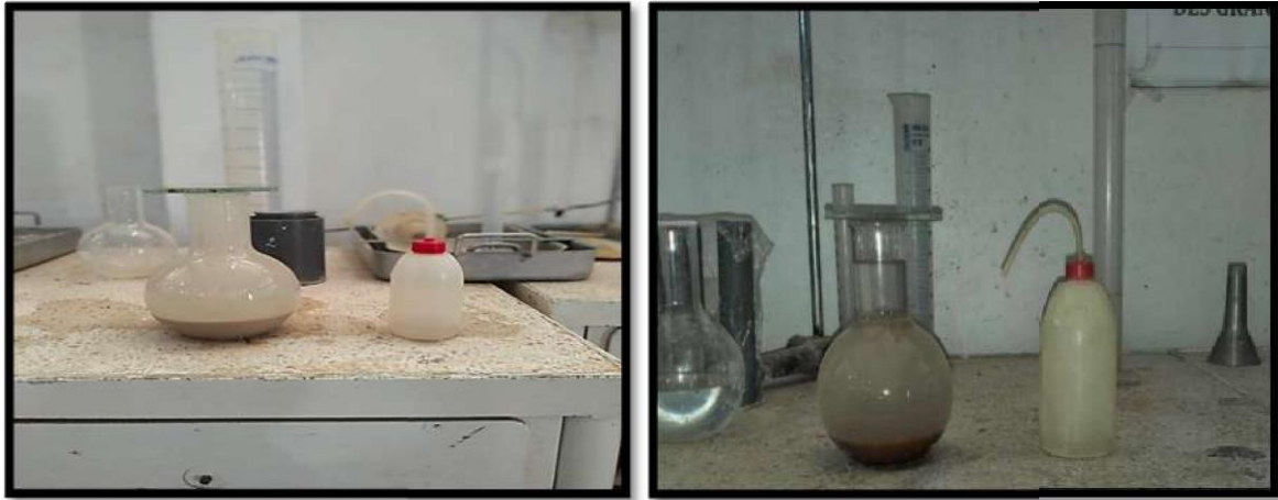
Figure 3.11 : Essai de détermination de la masse volumique absolue des sables.
