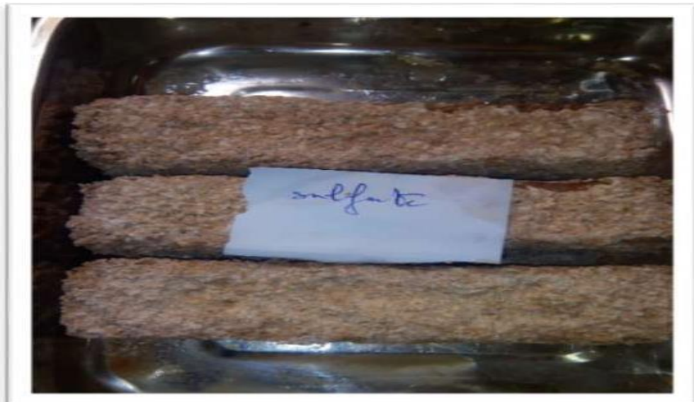
Figure 1.8 : Eprouvette du mortier conservée dans \text{H}_2\text{SO}_4 . [28]
