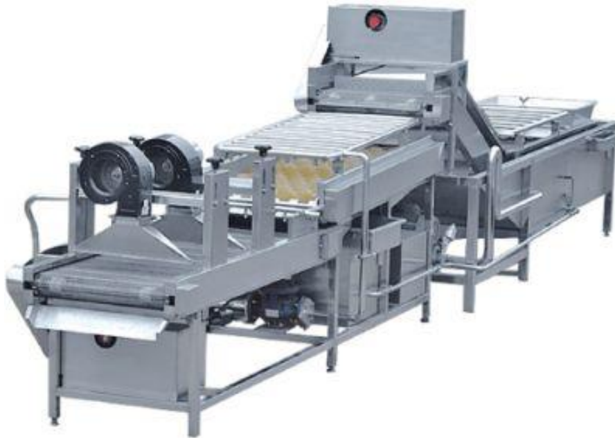
Figure 23 : Le nettoyeur industriel de l'équipement de ligne de lavage des fruits et légumes
