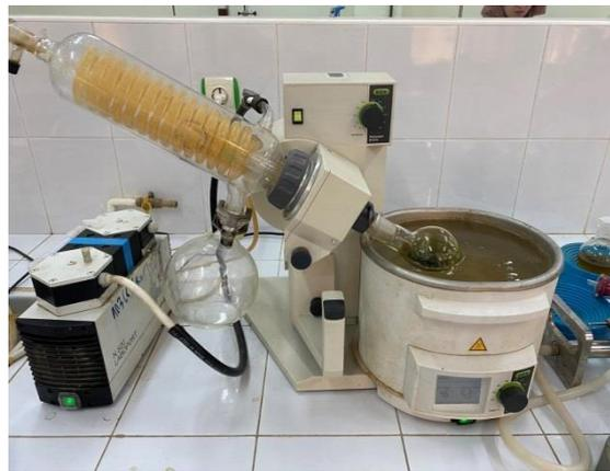
**Figure 6 :** Evaporateur rotatif (photo prise au laboratoire).
