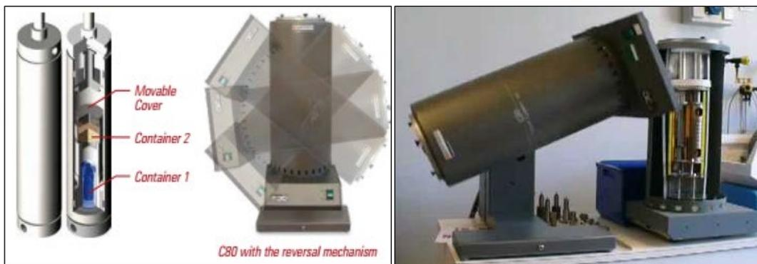
**Figure II.5 :** à gauche : Cellule de mélange à inversion ; à droite : calorimètre C80 inversé (utilisant le mécanisme d'inversion) [13].
