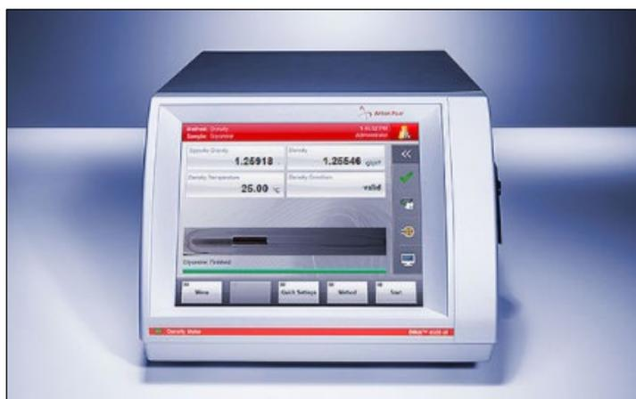
**Figure II.2** : densimètre Anton Paar model DMA™ 4500 [9].
