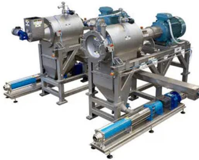
Figure 2: exemple d'un extracteur de jus à froid multifruit (JBT Corporation).
