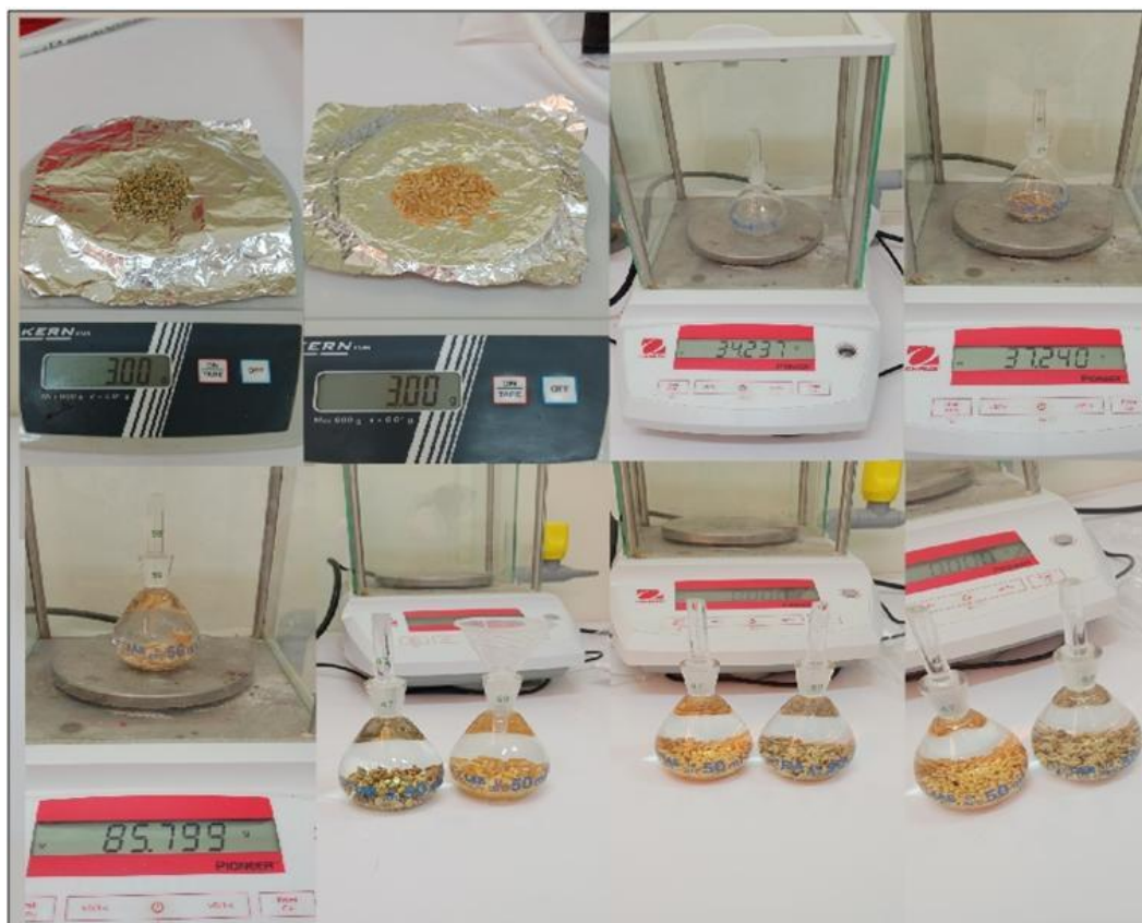
Figure 11: Les étapes de détermination de la densité des grains (originale).
