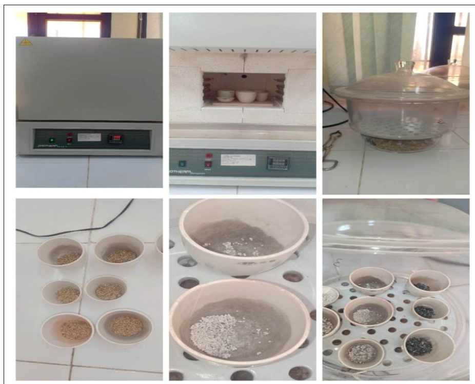
Figure 12: Détermination de la teneur en cendres des grains ( originale ).
