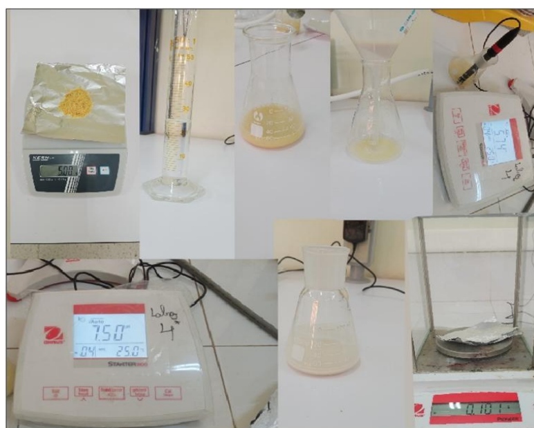
Figure 13: Mesure de PH des grains avec le PH mètre ( originale ).
