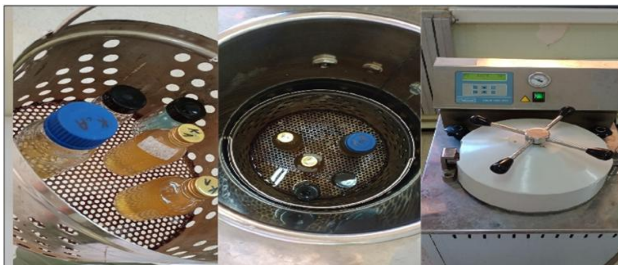
Figure 16: Stérilisation des flacons dans un autoclave ( originale ).
