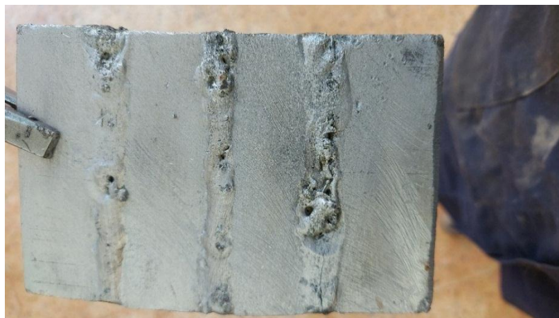
Figure II-6 l'effet de paquet de gaz à l'intérieure de cordon
