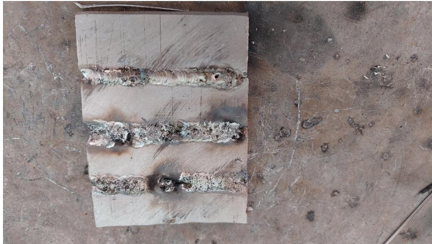
Figure II-7 l'effet de manque de gaz
