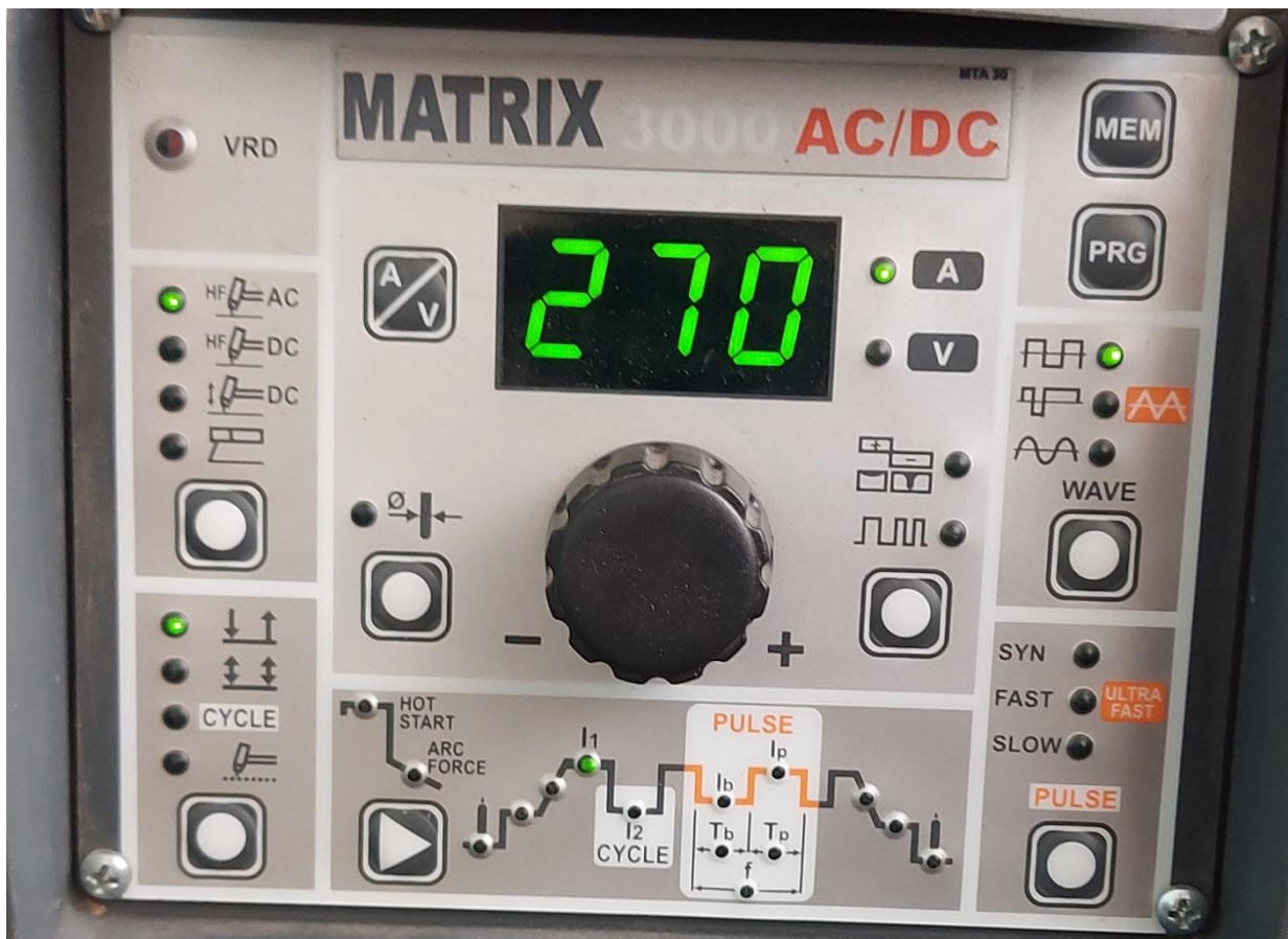
Figure II-5 Poste de soudage TIG (MATRIX 3000)
