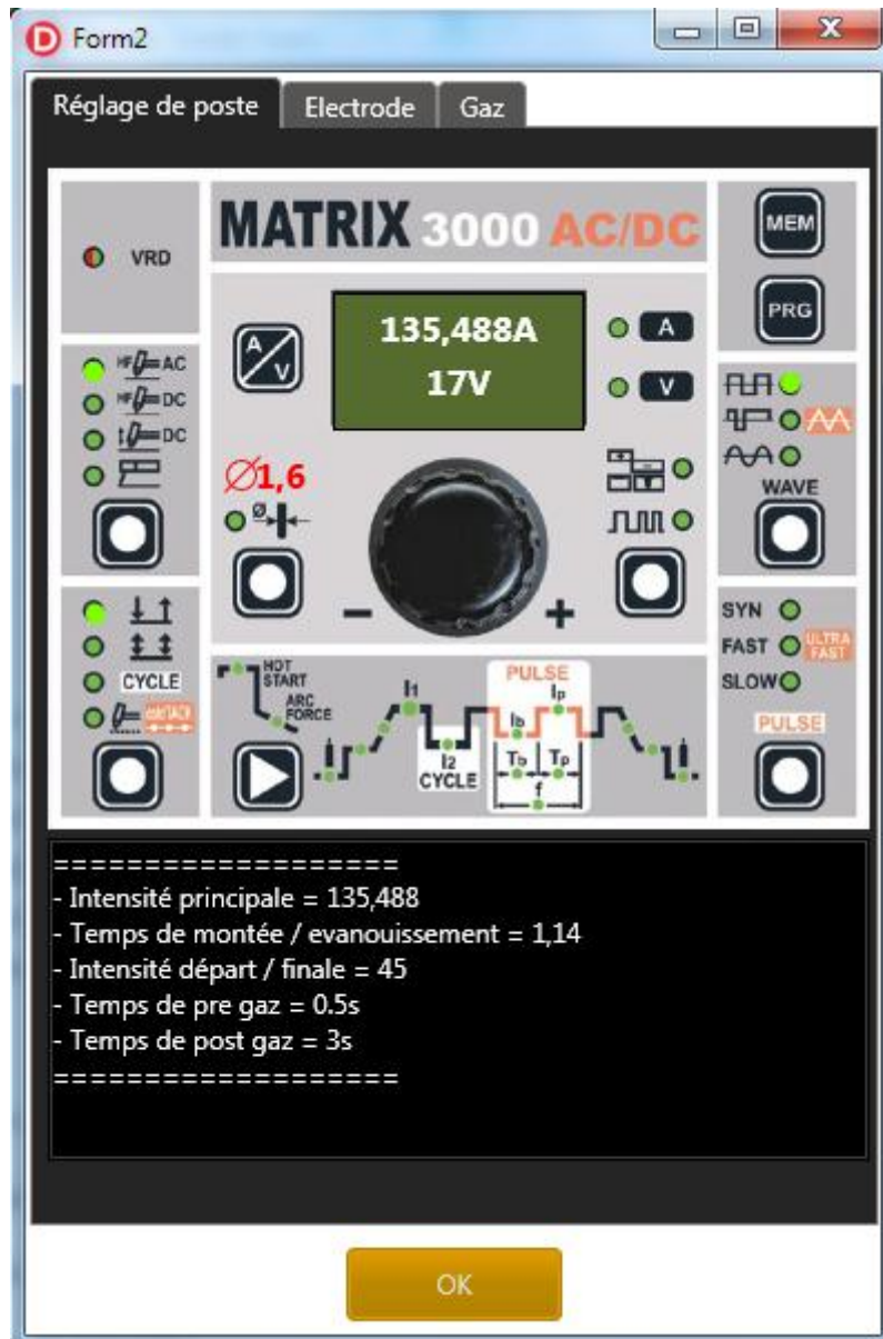
Figure III-11 L'interface de réglage de poste pour soudage bout à bout
