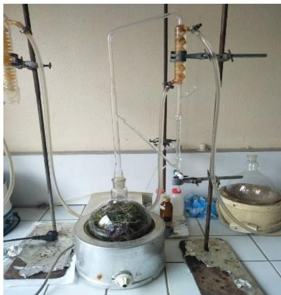
**Figure 04:** Appareil Clevenger d'extraction de l'huile essentielle par hydrodistillation
