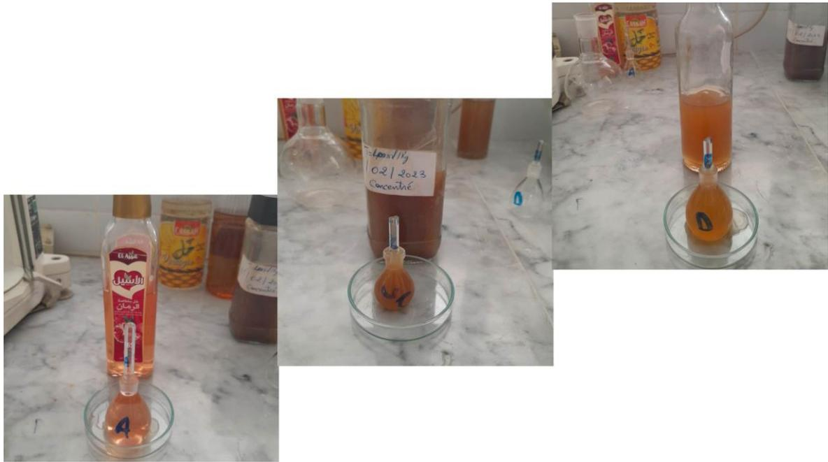
Photo III-11 Quelques échantillons étudiés dans des pycnomètres
