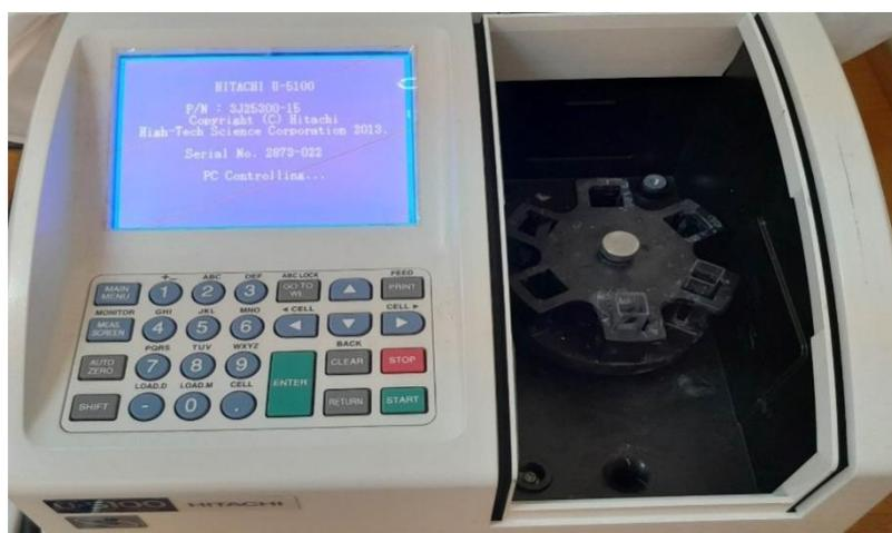
Photo III- 18 Spectrophotomètre "Hitachi U-5100"
