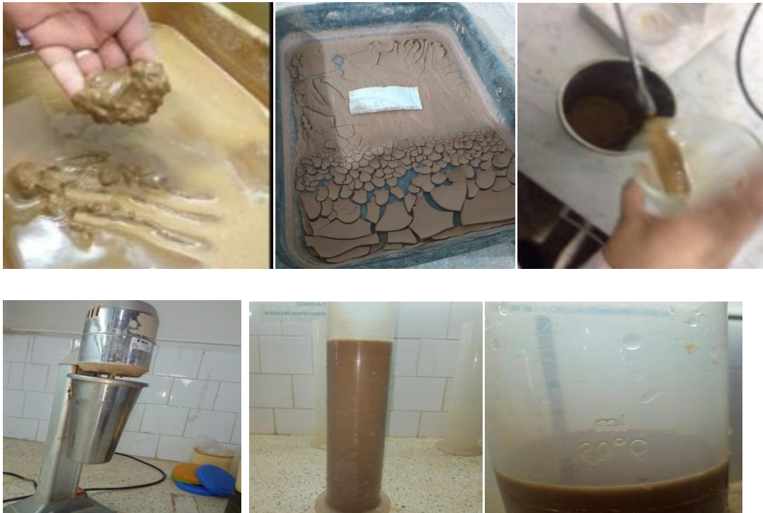
Figure 357: L'essai Sédimentométrie (original, 2023)
