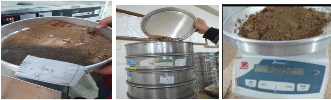
Figure 36: L'essai granulométrique (original, 2023)
