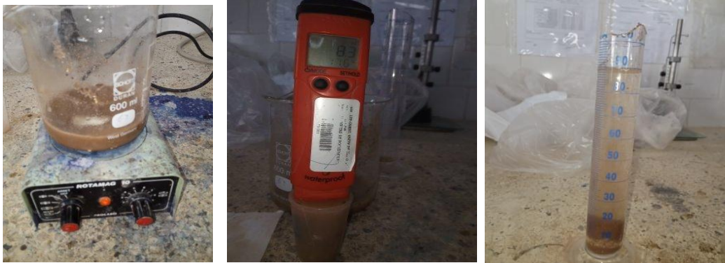
Figure 35 : les étapes de détermination du pH du sol (original, 2023)
