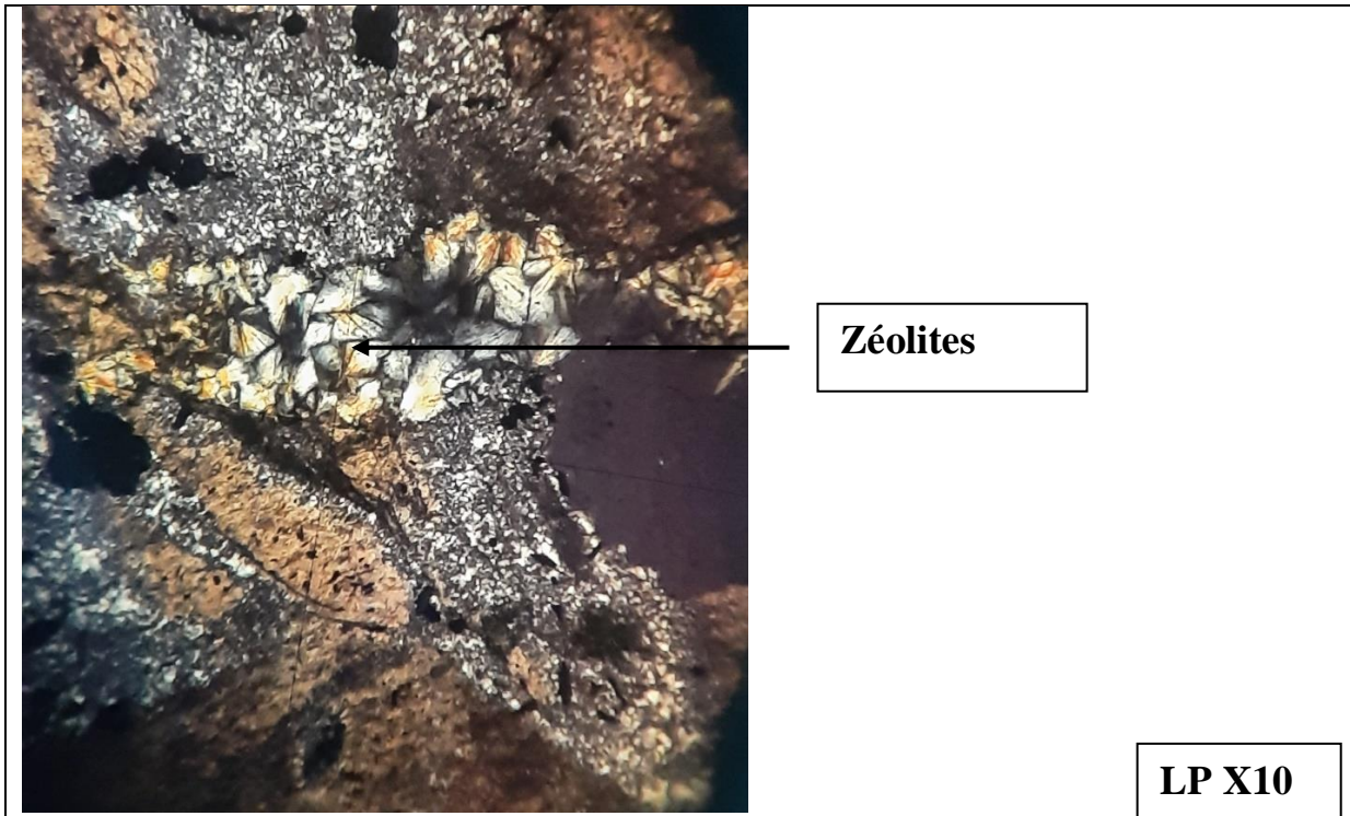
Fig.36. Microphotographie montrant la transformation de verre volcanique en zéolites caractéristiques dans une andésite.
