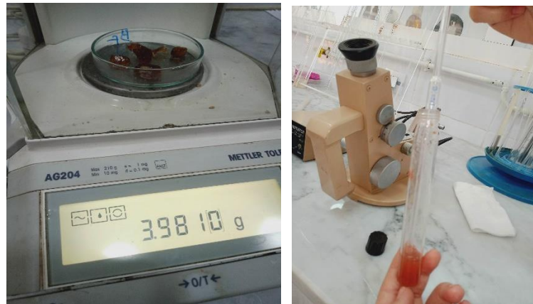
Figure 45 : Détermination du degré de Brix (photo originale)
