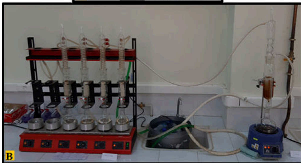
Figure 12 : (A) : Schéma simplifié de Soxhlet ; (B) Montage de dispositif d'extraction Soxhlet avec circuit fermé d'eau de refroidissement
