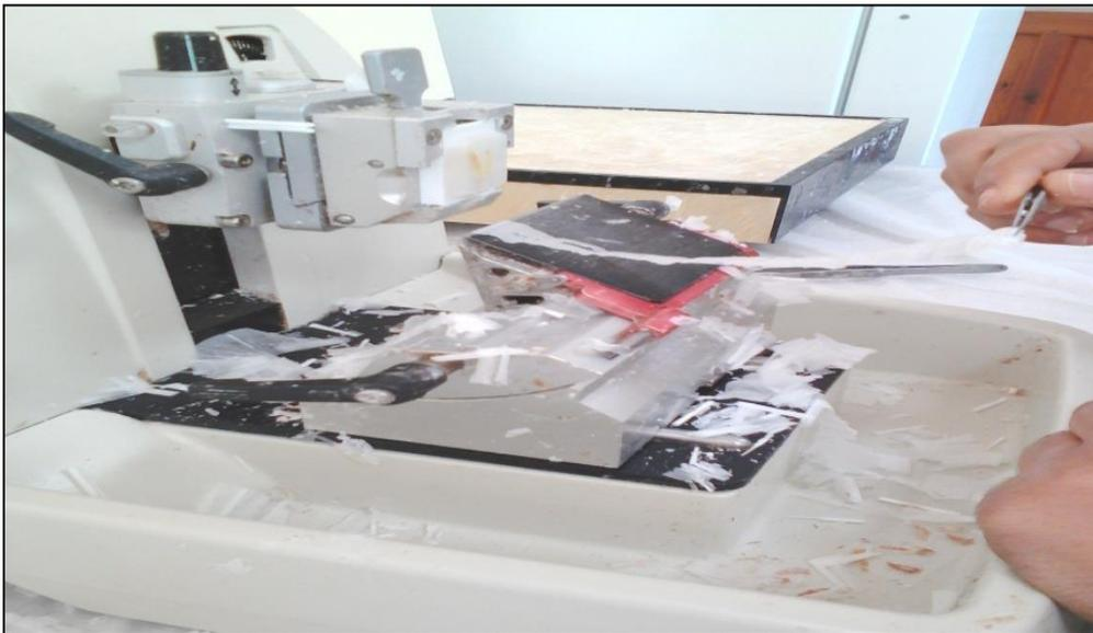
**Figure 5.** Réalisation des coupes de prélèvement tissulaire à l'aide d'un microtome
