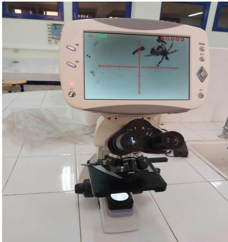
**Figure 30:** Microscope optique à caméra (photo originale)
