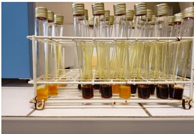
**Figure 09** : Coloration des tubes après l'ajout du DNSA.
