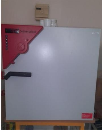
fig. 4:Four de séchage
