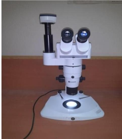
**fig. 12:**Loupe binoculaire équipée d'une caméra.
