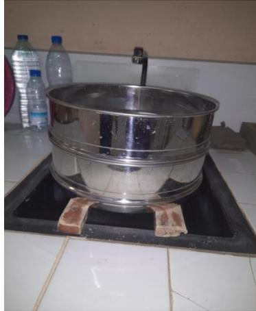
fig. 5:Tamis 400µm 710µm.
