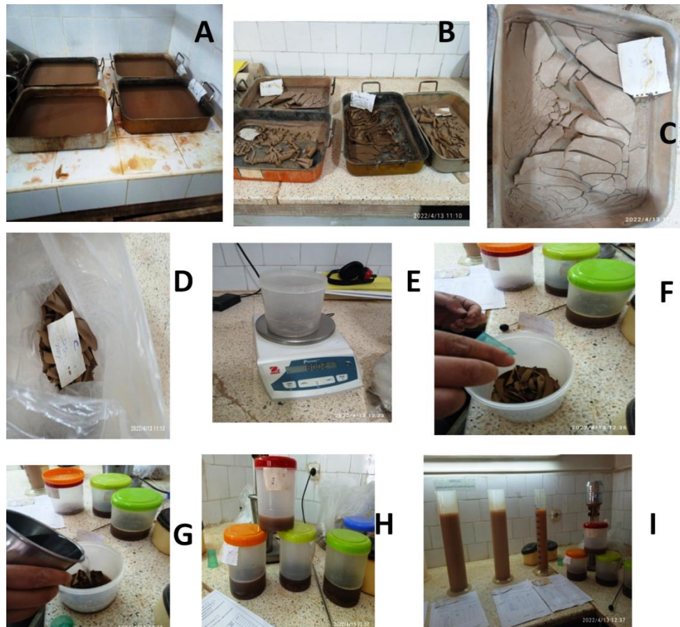
Figure 10 : ABC : Recueillir et Siphonner l'eau du bac ; DEF : prélever une prise d'essai de 80g ; GHI : Introduire la prise d'essai dans le récipient
