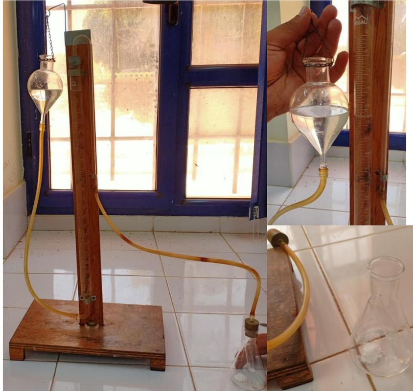
**Photo 15 : L'utilisation du Calcimètre de Bernard dans l'expérience du Carbonate de calcium ( $\text{CaCO}_3$ ) pur (BELOUFA, 2023).**
