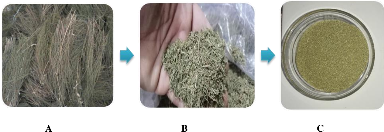
Figure 6 : Les étapes de la préparation de l'échantillon : Séchage (A) , Découpage (B) et Broyage (C).
