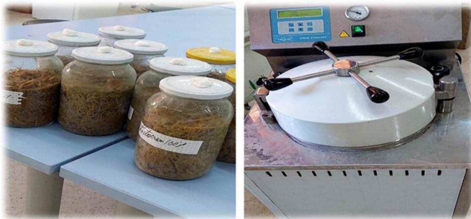
**Figure 11** : Stérilisation par l'autoclave (photos Originales).
