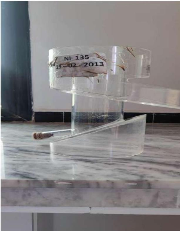
**figure 25 : l'appareil de fenwik**
