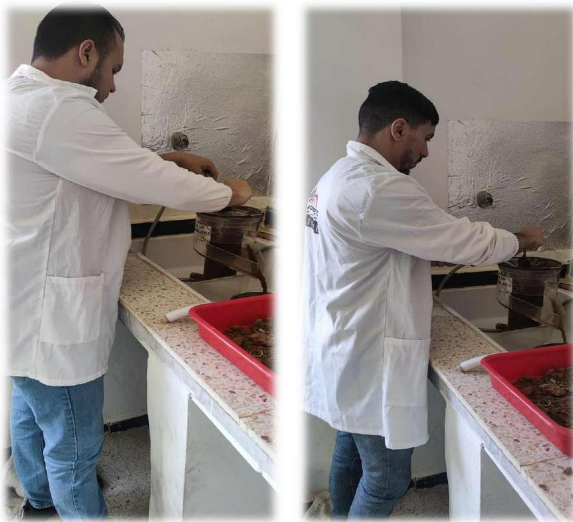
**Figure N°35 : utilisation de l'appareil de FENWIK dans laboratoire (Original, 2023)**
