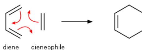
Figure 17 : Réaction de Diels-Alder.
