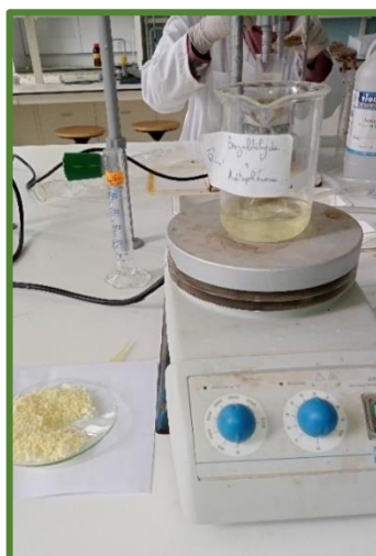
Figure 68: Montage de recristallisation.
