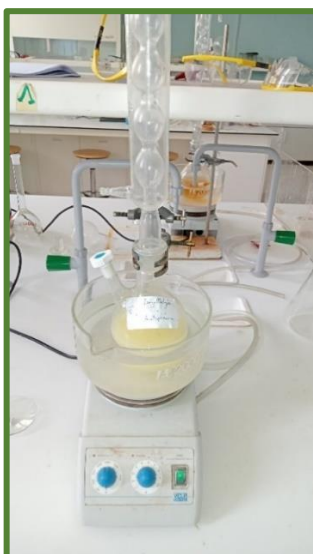
Figure 66: Montage employé dans la synthèse des chalcones.
