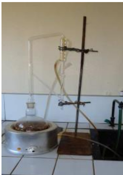
Photo 4: Dispositif Clevenger pour l'extraction des huiles essentielles par hydrodistillation
