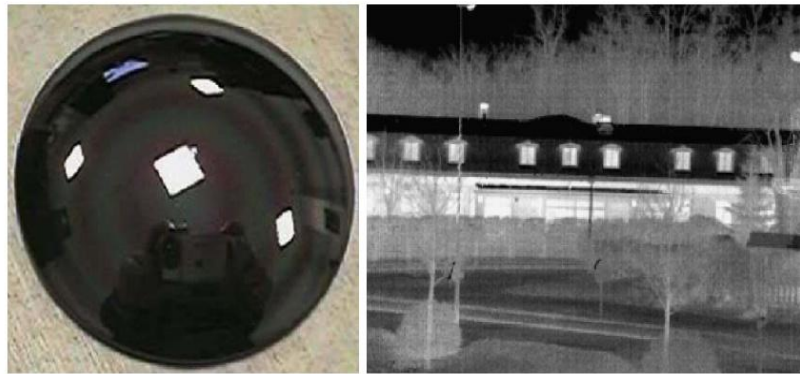
Figure 2. 20 : Image d'une lentille asphérique en verre chalcogénures sur la gauche et une photo prise avec un appareil de vision nocturne équipé d'une lentille en verre chalcogénures sur la droite [53].
