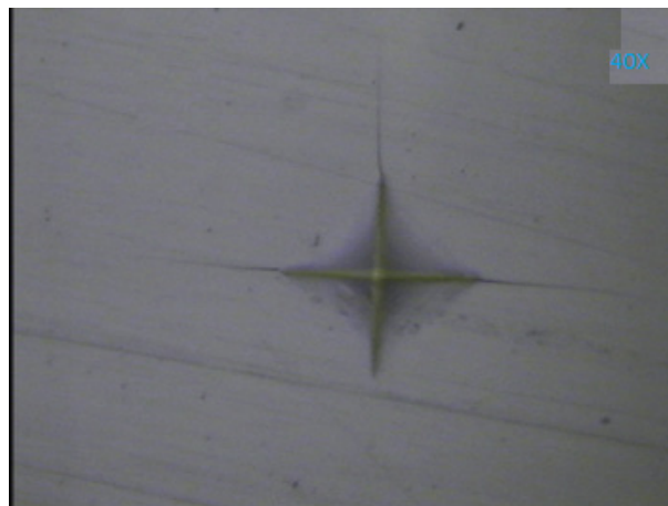
Figure 4. 5- Observation au microscope optique (x40) de la trace d'une indentation de 1N sur l'échantillon de \text{GeSe}_9 .
