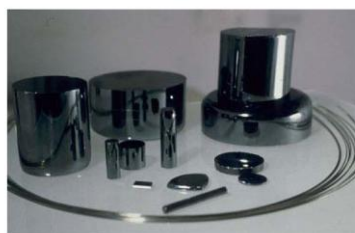
Figure 2. 6 : Exemple du verre chalcogénure: le verre massif et la fibre \text{Te}_2\text{As}_3\text{Se}_5 (image obtenu par Prof. J. Lucas de l'université de Rennes I).
