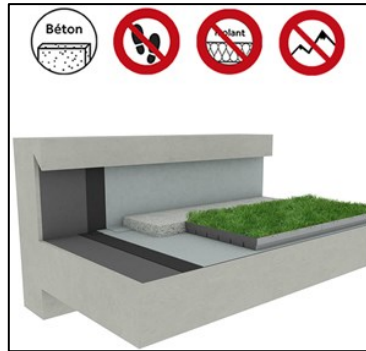
Figure 81: Toiture-terrace végétalisée béton.
