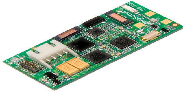
Figure I.9 : étiquette RFID active
