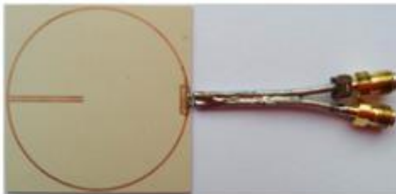
Figure II. 4 : (a) Antenne miniature différentielle inspirée d'une IFA chargée par une capacité distribuée [II.16].
