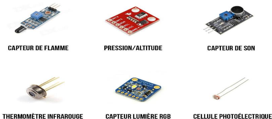
Figure I.3 : capteurs pour mesurer des variables physiques dans un environnement [9].
