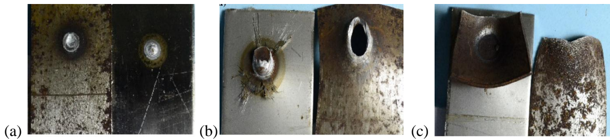
Figure 28 : Modes de rupture pour des joints hétérogènes [20].
