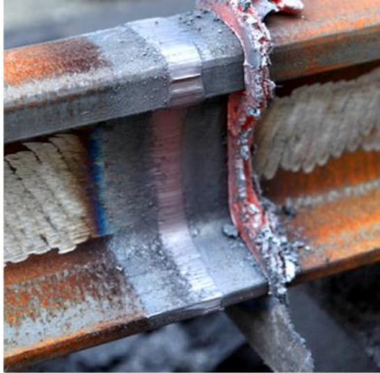
Figure 3 : Procédé de soudage par étincelage [4].
