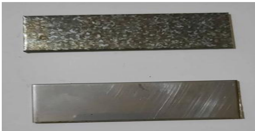
Figure 1 : Epreuves avant l'opération de soudage.
