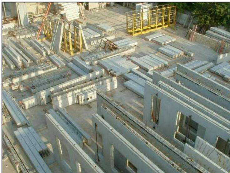
Figure 16 : usine de préfabrication, Source : [http://www.hanny.fr/?page\\_id=37534](http://www.hanny.fr/?page_id=37534)
