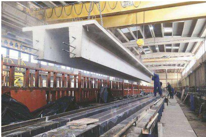
Figure15 : Poutre préfabriquée Source : <https://www.cahiers-techniques-batiment.fr/article/la-prefabrication-pour-des-realizations-d-exception.39566>
