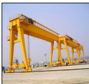
Figure 59 : Grues à portique. (Source : https://image.made-in- )
