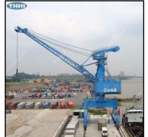
Figure 61 : Les grues mobiles sur rail (Source : https://image.made-in- )
