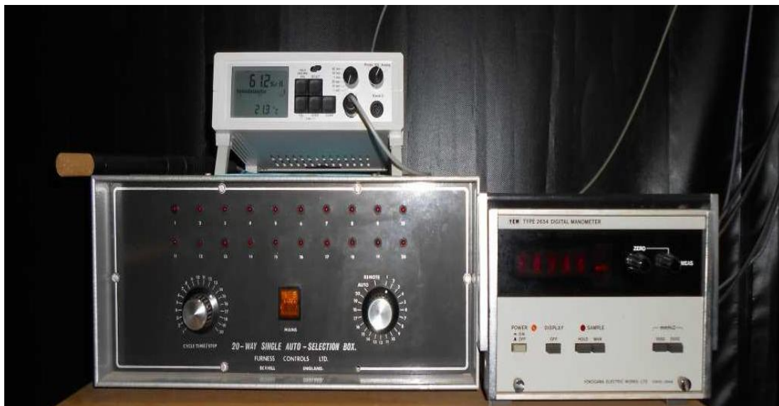
Figure III.4: Thermo-hygromètre DOSTMANN T870, Mesures de pressions : Sélecteur Bexhill 20 voies, Manomètre YAW 2654
