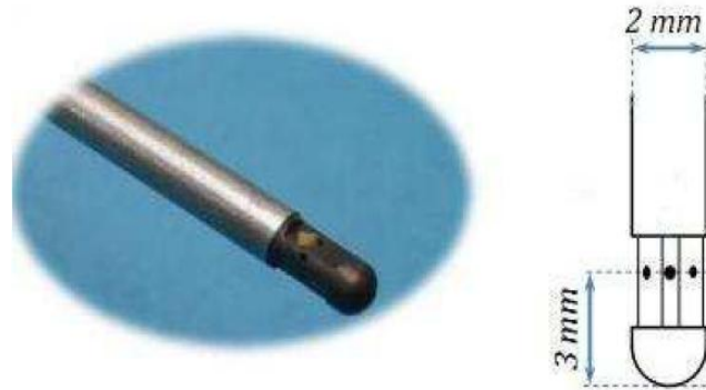
Figure III.10: Schéma et photo de la sonde 3 trous
