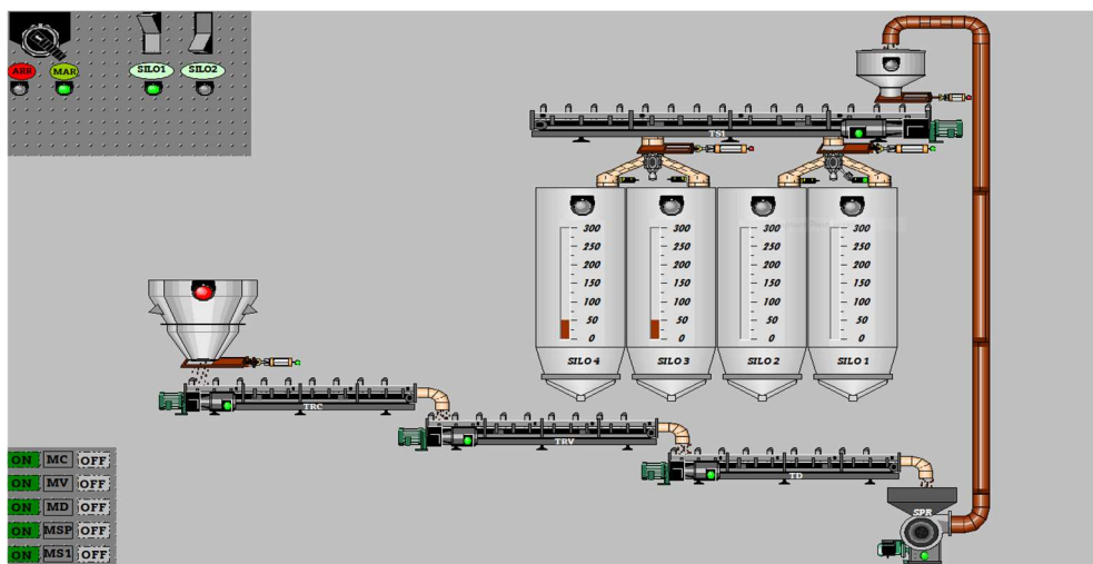
Figure 4.23 la supervision de système en état de chargement de site
