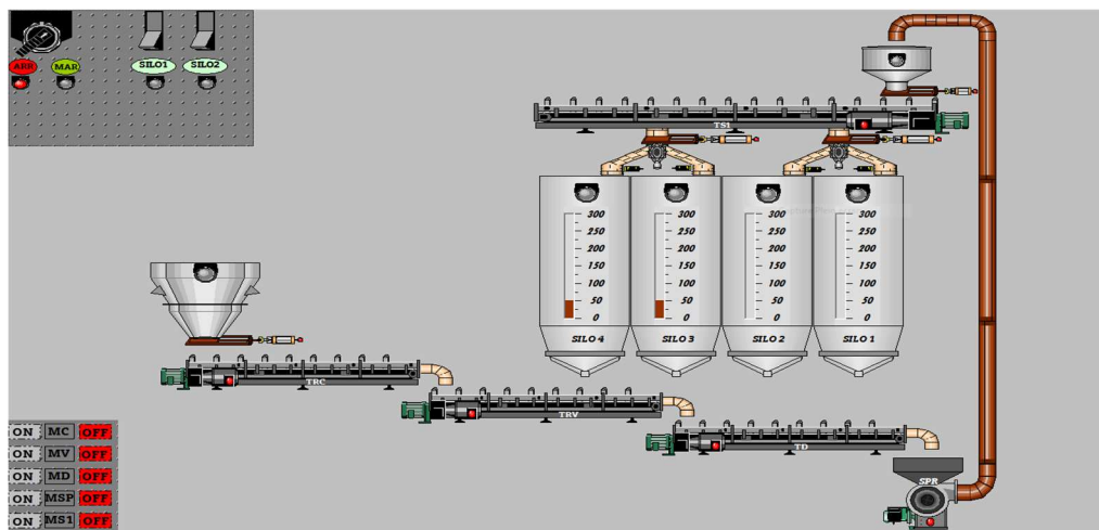
Figure 4.19 supervision de système en état d'arrêt
