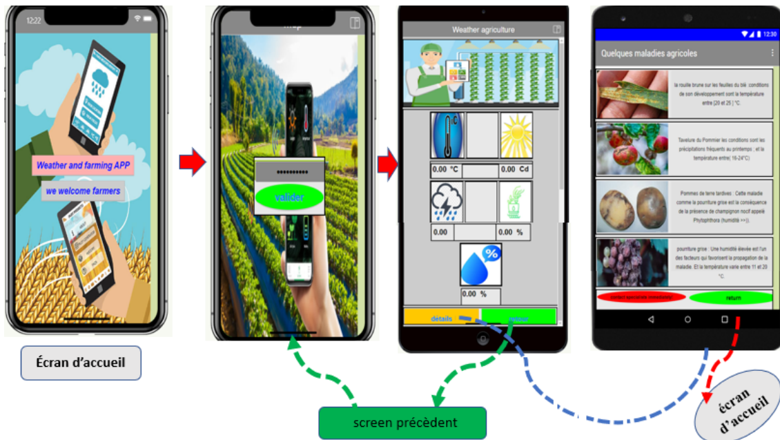
Figure 3.15 – Les quatre fenêtres principales d'accès à l'application et et aux différents paramètres mesurés avec les maladies.
