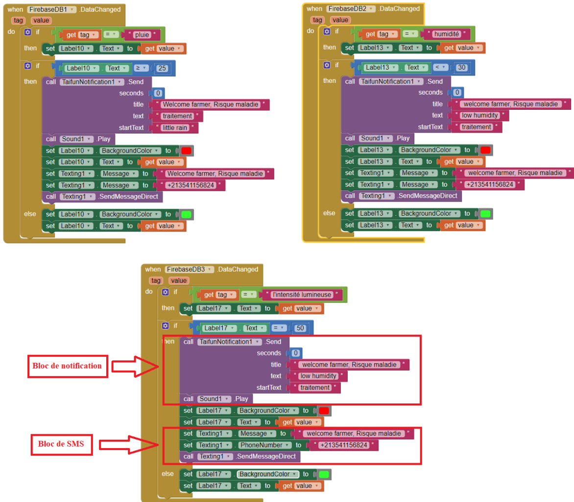
Figure 3.18 – Bloc DB1, DB2 et DB3 qui ont pour fonction la vérification et l’affichage des paramètres pluie, intensité lumineuse et humidité avec notification et sms.
